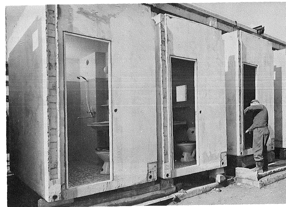
Figur 5.10 Klargøring af units på fabrikken hos Larsen & Nielsen.
